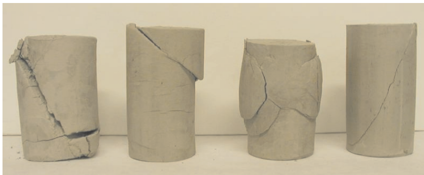
Obr. 13a Porušení vzorku zemin po zkoušce CIUP
