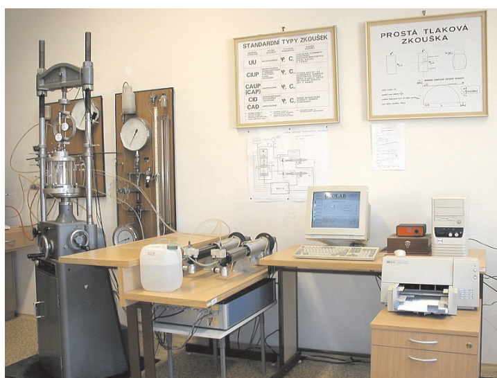
Obr. 13b Automatizovaný systém pro realizaci triaxiálních zkoušek
