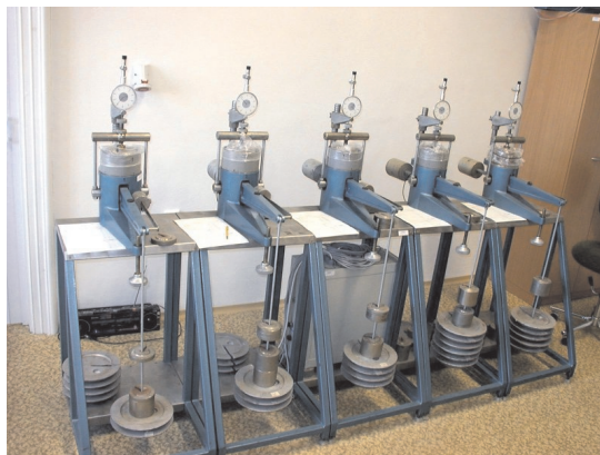
Obr. 13d Edometry - přístroje pro zjištění přetvárných charakteristik
