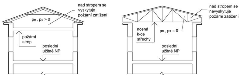
Obr.5.4.4: Posouzení stropu nad posledním užitným NP
