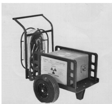
Obr. 9.1 Defektoskopický kryt se zářičem Co60
