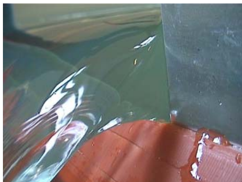
Obr. 2.1 Boční kontrakce při zúžení průřového profilu
