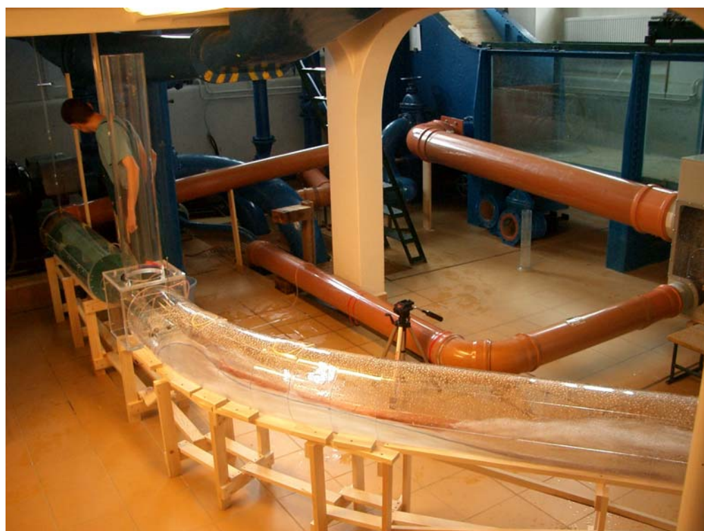
Obr.5.11 Model spodní výpusti v měřítku 1:20 hrazené segmentem (VD Les Království – řeka Labe)
