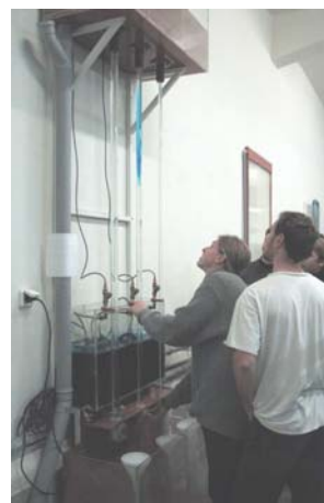
Obr.2.4 Laminární a turbulentní proudění (Reynoldsův pokus)
