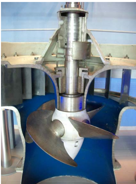
Obr.5.17 Řez Kaplanovou turbínou (Technické muzeum v Brně)
