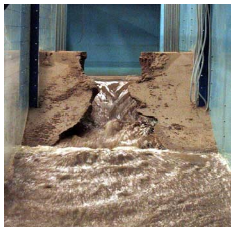
Obr.5.21 Přelití koruny hráze
