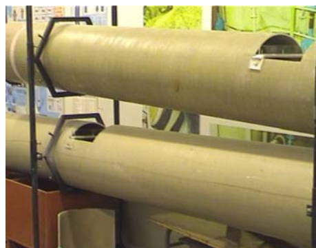
Obr.5.19 Měrná trať na zkoušení trubních materiálů s ukázkou kameniva
