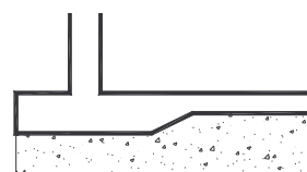
Obr. 3.2: Úprava dna u nestlačitelných půd
