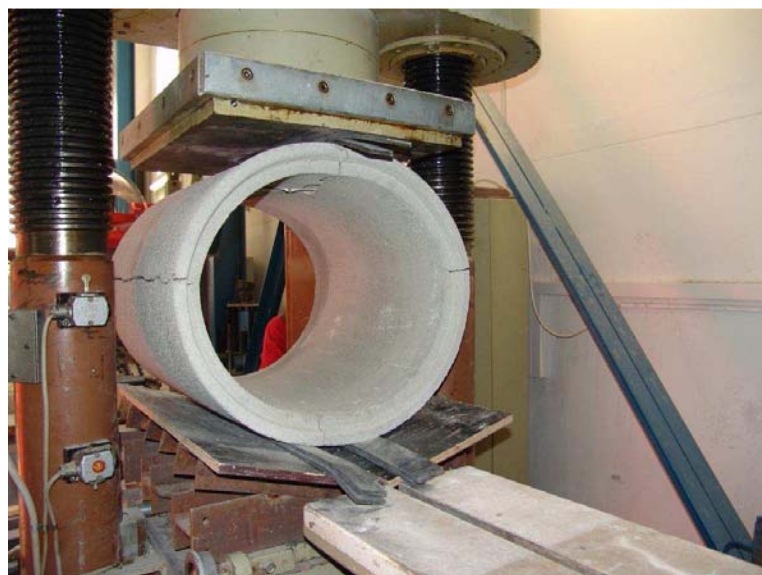
Obr. 5.5: Zkouška vrcholovým tlakem – porušené potrubí
