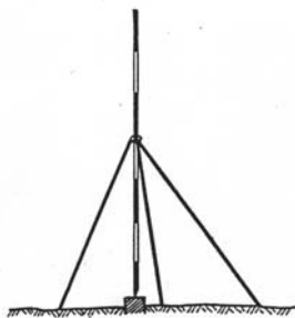
Přechodná signalizace výtyčkou
